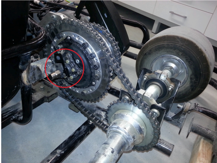
Şekil 3.18. Hız sensörü ve manyetik civatalar aks yerine şanzıman çıkış tekerleği eksenine üzerine yerleştirilmiştir.
