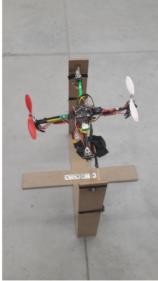
Şekil 3.9: Yalpa ve Yunuslama Kontrolcü Katsayı Ayarlaması için Kullanılan Test Düzeneği
