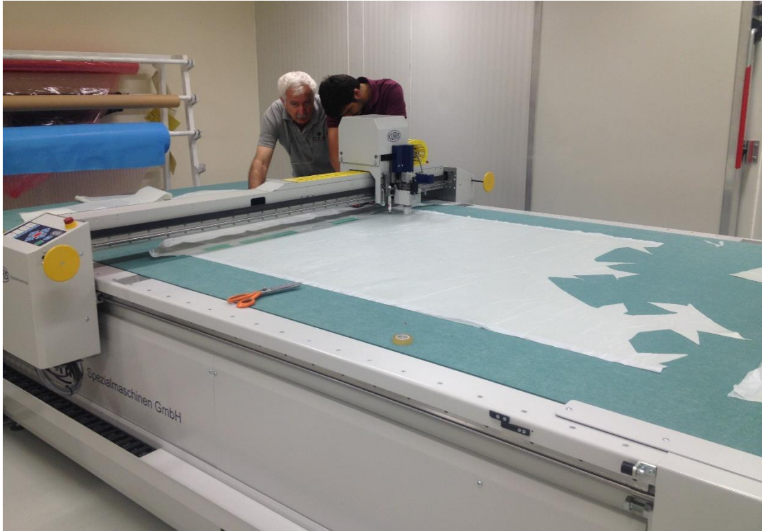
Şekil 4.5. CNC katman kesim tezgahında katmanların kesim işlemi.
