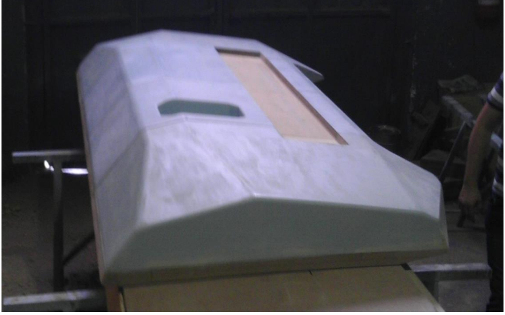
Şekil 4.1. Kompozit üst kabuk yapısının hazırlık aşamasındaki mdf modeli.
