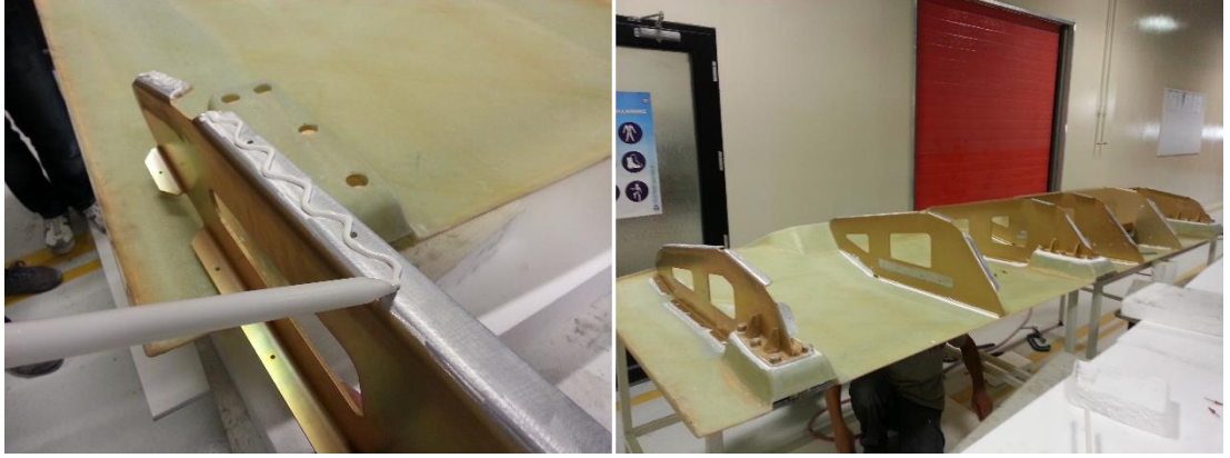
Şekil 4.11. Alüminyum kaburgaların kompozit yapıyla birleştirilmesi.
