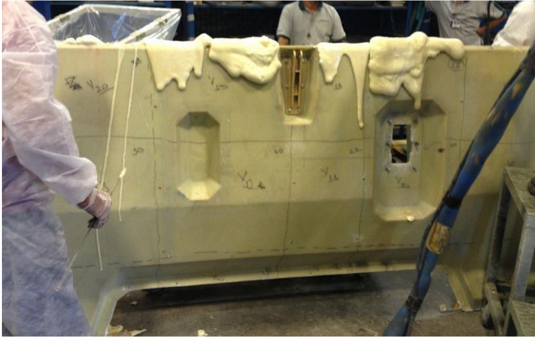
Şekil 4.13. Denge plakası yapısının içine poliüretan köpük doldurulması.
