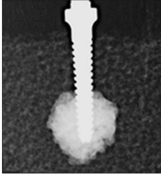
Şekil 5.1. PMMA katkılı sabitleme film görüntüsü. PMMA'nın kemiğin radyal deliklerinden taşarak geniş bir alana yayıldığı görülmektedir [57].
