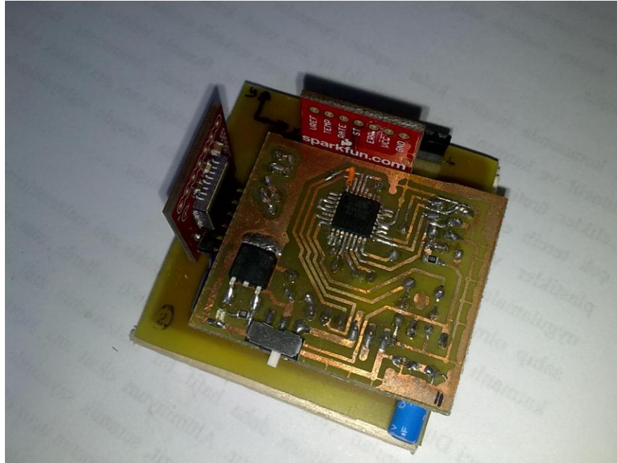
Şekil 3.8. Ölçüm kartı ve okuyucu kart birleştirilmiş ataletsel ölçüm birimi
