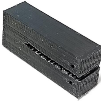
Şekil 1.19 : Çift Konsol Kiriş Testi için Numune Örneği [31]
