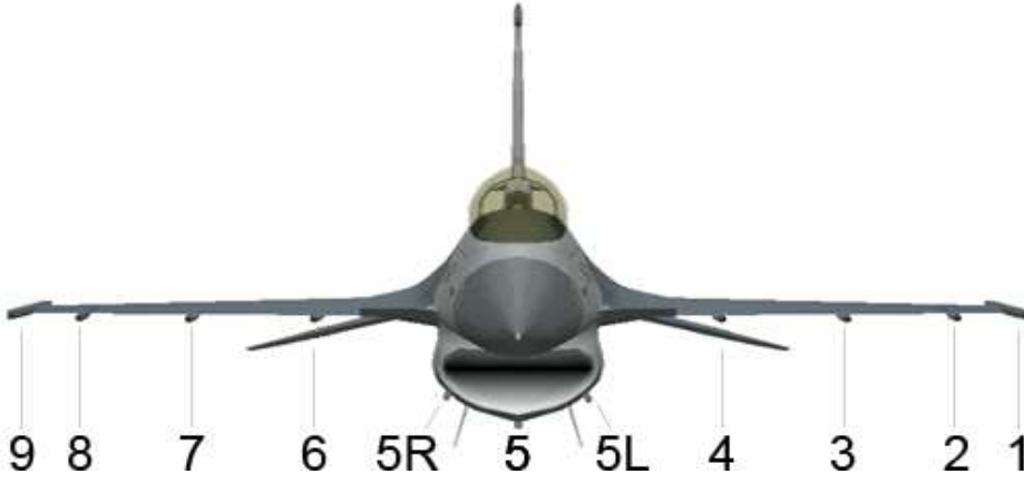
Şekil 1.4 : F/16 uçağı faydalı yük istasyonları [16].
