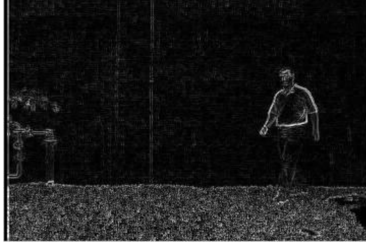
Şekil 4.24 İlk Videonun Kernel Filtresine Hem Yatay Hemde Dikey Uygulanması Sonucu Oluşan Toplam Resim Karesi
